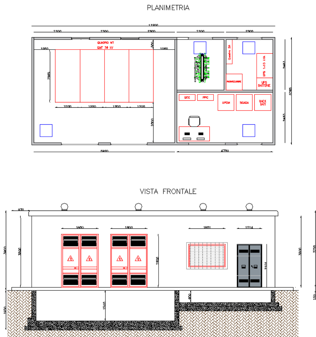
FIGURA 5- PARTICOLARE CABINA PRODUTTORE
